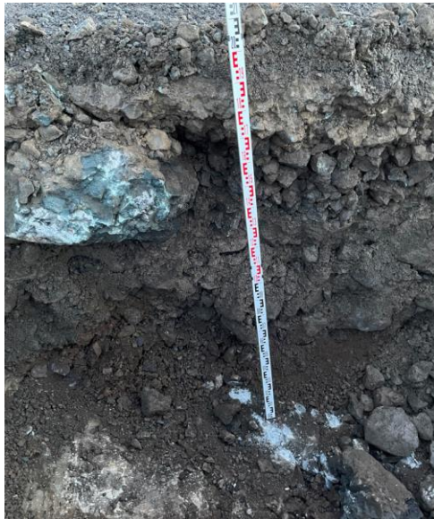
Mynd 2.1 Prufuhola A. Efni með víða kornastærðardreifingu.
