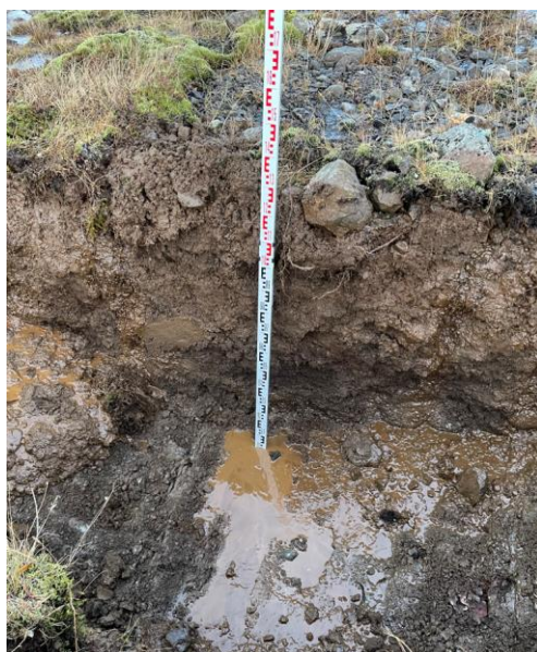
Mynd 2.12 Prufuhola E. Moldarblandaður jarðvegur niður á klöpp
