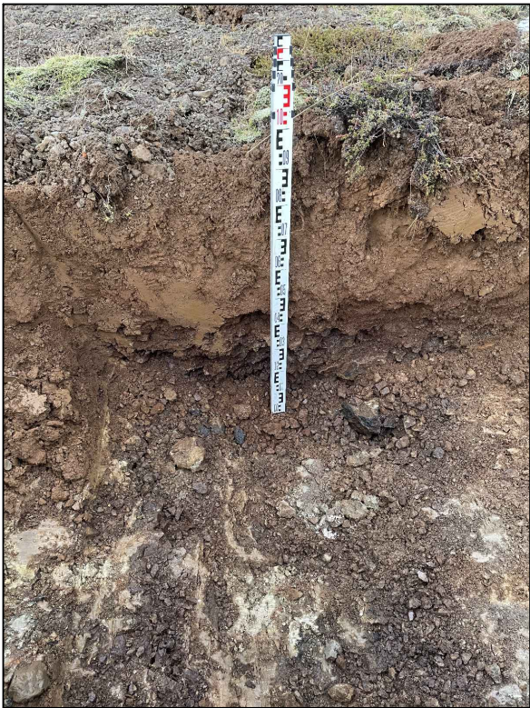
Horft í Holu D. Moldarblandaður jarðvegur efstu 0,7 m. Frá 0,7-0,9 m er lag af grús og þar undir klöpp.
