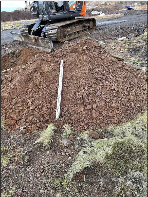
Jarðvegur úr holu D. Grús og einstaka steinar á yfirborði og í moldarblandaða jarðveginum. Mælistika er 1m á lengd.
