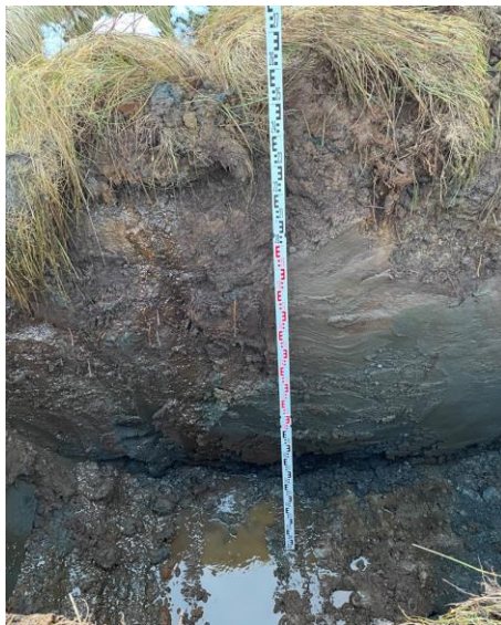
Mynd 2.15 Prufuhola F. Þéttur mýrarjarðvegur niður á klöpp.
