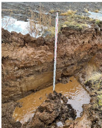
Mynd 2.6 Prufuhola C. Moldarblandaður jarðvegur niður á klöpp.
