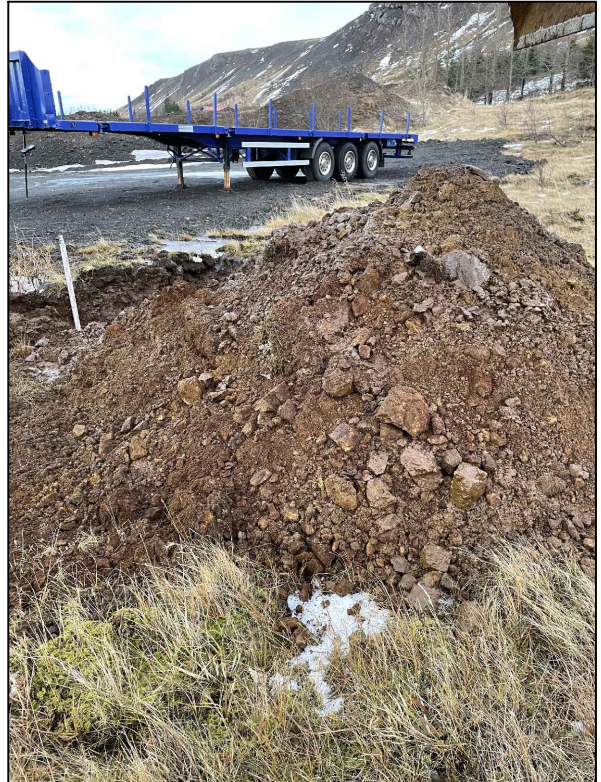
Núverandi jarðvegur úr holu C. Einstaka steinar á yfirborði og í moldarblandaða jarðveginum.
