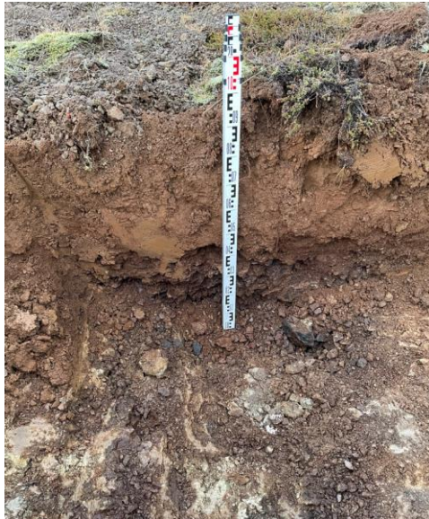
Mynd 2.10 Prufuhola D. Moldarblandaður jarðvegur niður á klöpp
