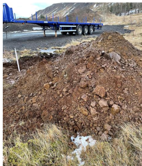
Mynd 2.7 Uppgraffinn jarðvegur úr prufuholu C. Moldarblandaður jarðvegur með stöku steinum.
