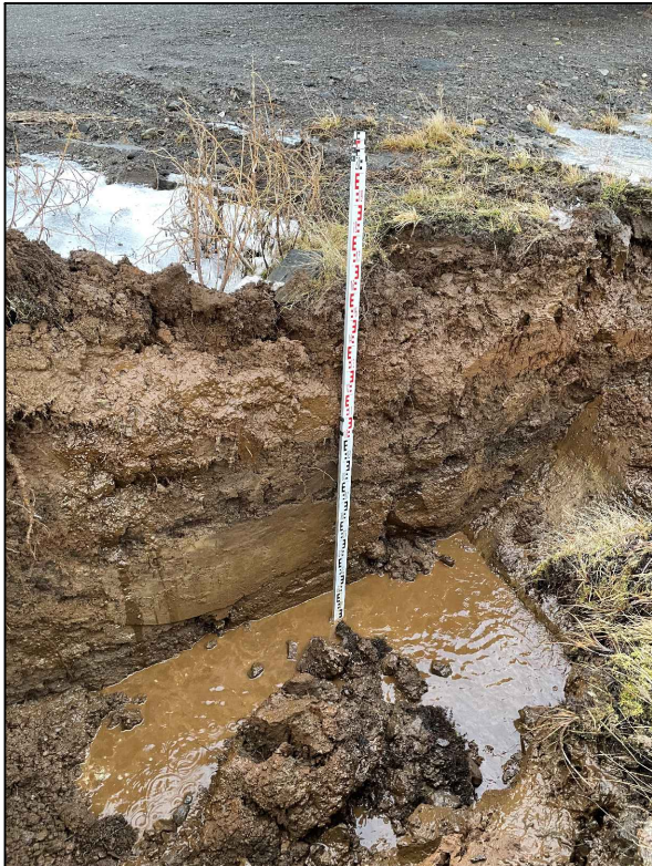
Horft í Holu C. Moldarblandaður jarðvegur 1,4 m þykkur niður á klöpp.
