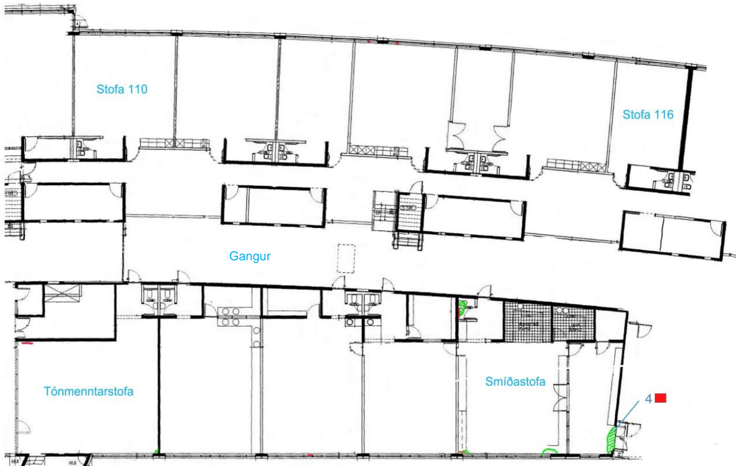
MYND 6: Grunnmynd 1.og 2. hæðar, stofur 110-116 ásamt gangi og ýmsum rýmum á 2. hæð – rakaummerki og sýnatökustaðir merktir inn á teikningu.
