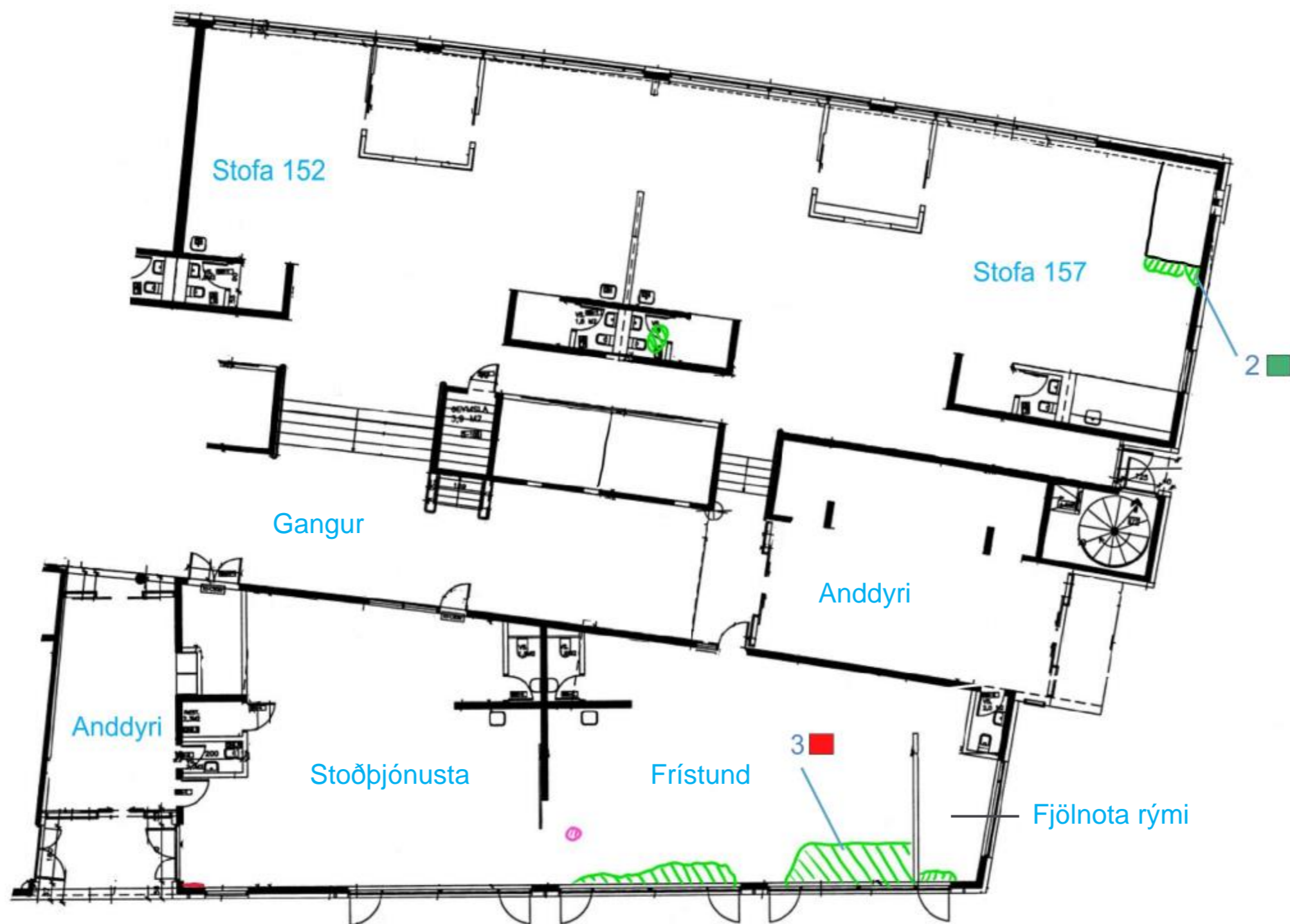
MYND 5: Grunnmynd 1. og 2. hæðar, stofur 152-157 ásamt gangi og ýmsum rýmum á 2. hæð – rakaummerki og sýnatökustaðir merktir inn á teikningu.
