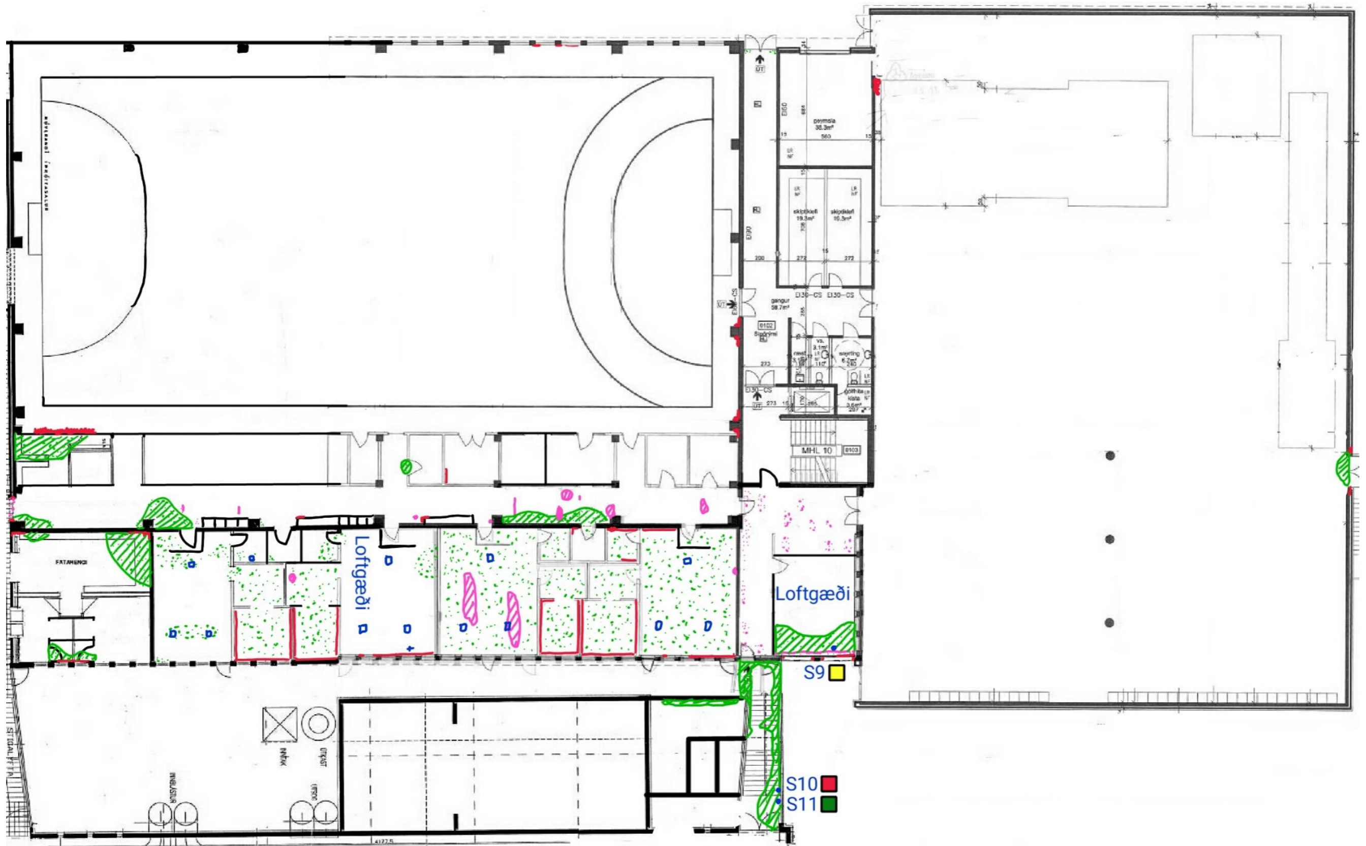
MYND 3: Íþróttahús, 1.hæð - salur 3, fimleikasalur og búningsklefar – rakaummerki og sýnatökustaðir merktir inn á teikningu.
