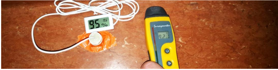
MYND E Dæmi um hlutfallsrakamæli sem settur er í gólf undir dúk til að mæla raka í steypu og samanburður við non invasive eða snertirakamæli sem er lagður á gólfplöt til að mæla raka.
