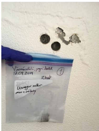
MYND 6: Sýni 1–Yngri deild, 2.hæð, austurálma, útteggur suður, múr, málning.
